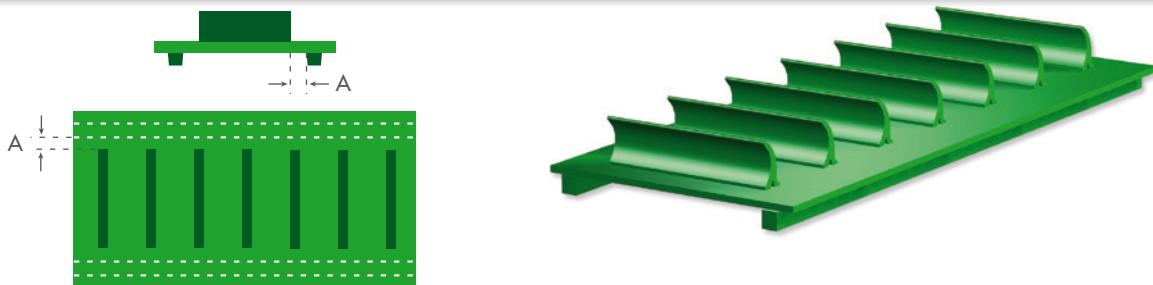
**APPLICATION SPECIFICATIONS - Specifiche applicazione - Especificaciones de aplicación****A MINIMUM - A minimo - A mínimo = 10 mm**
