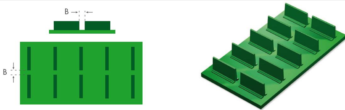
**APPLICATION SPECIFICATIONS - Specifiche applicazione - Especificaciones de aplicación****B MINIMUM - B minimo - B mínimo = 10 mm**
